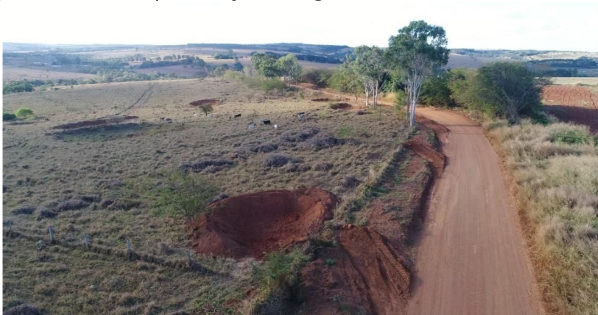
Imagem 01 – Cacimba realizada em zona rural do município de Anápolis
